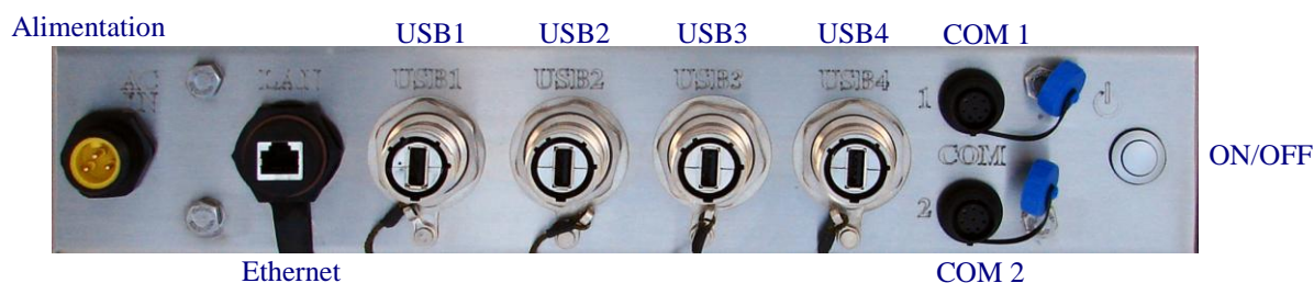
Figure 1 Vue dessous TermiCom SE-15
